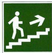
Направление к эвакуационному выходу по лестнице вверх
