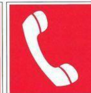
Телефон для использовани при пожаре (в том числе телефон прямой связи с пожарной охраной)
