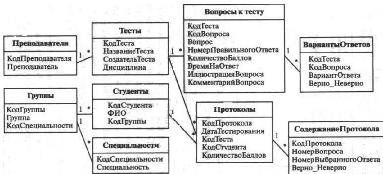
Рисунок 7 – Пример диаграммы «сущность-связь» автоматизированной тестовой системы
